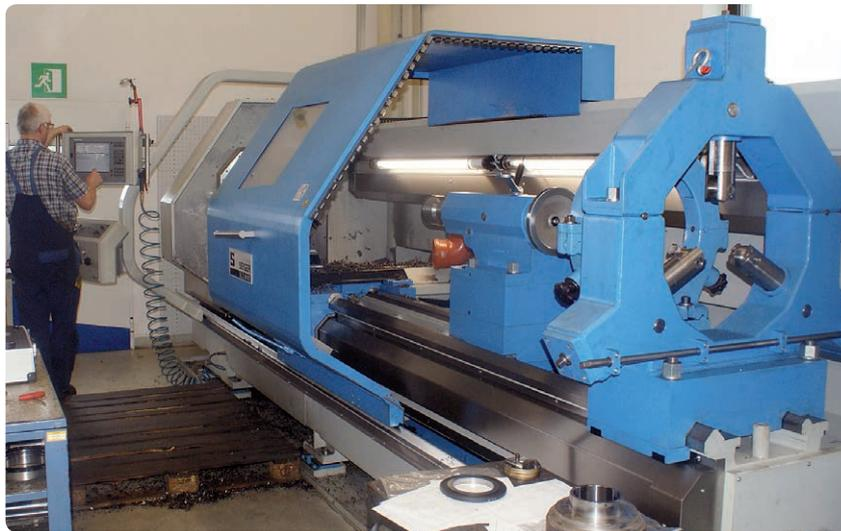
Der Maschinenpark von Enke ist breit aufgestellt. Im Bild beispielhaft eine Zylinderdrehmaschine von Seiger.
