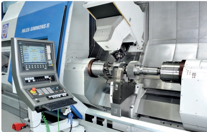
Arbeitsraum des CNC-Bearbeitungszentrum N30 MC von Niles-Simmons.
